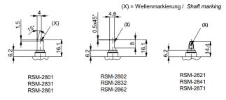
Empfohlene Gegenkontur der Antriebswelle für Recommended dimensions of driving shaft for
