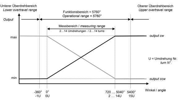
5.2 Ausgangssignal bei Messbereich 15 oder 16 Umdrehungen / Output signal with measuring range 15 or 16 turns
